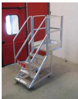
Scale con ruote e piattaforma a sbalzo per accostamento a macchinari e linee di produzione, unibili fra di loro onde formare un unico pianerottolo
